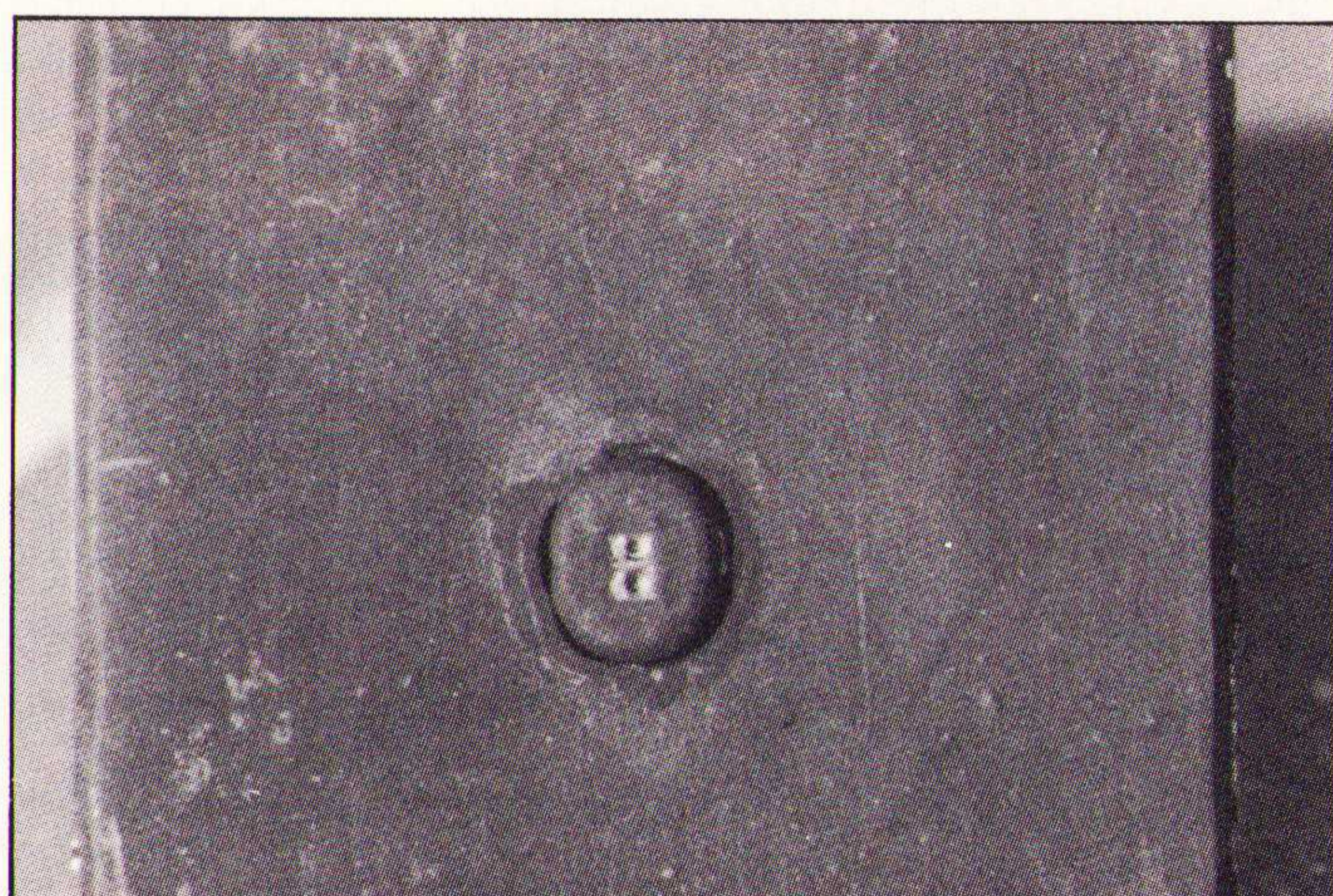
Afb. 12 Het diafragma op de blauwe dubbel-LED is rechthoekig van vorm en wordt met een zeer dunne penseel (nr. 00) met mat zwarte modelbouwverf op de LED geschilderd (evenals onder andere het tussenschot waarin de LED gemonteerd is).
